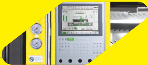
自动化控制 全系采用KEBA2980 工业自动化电脑
