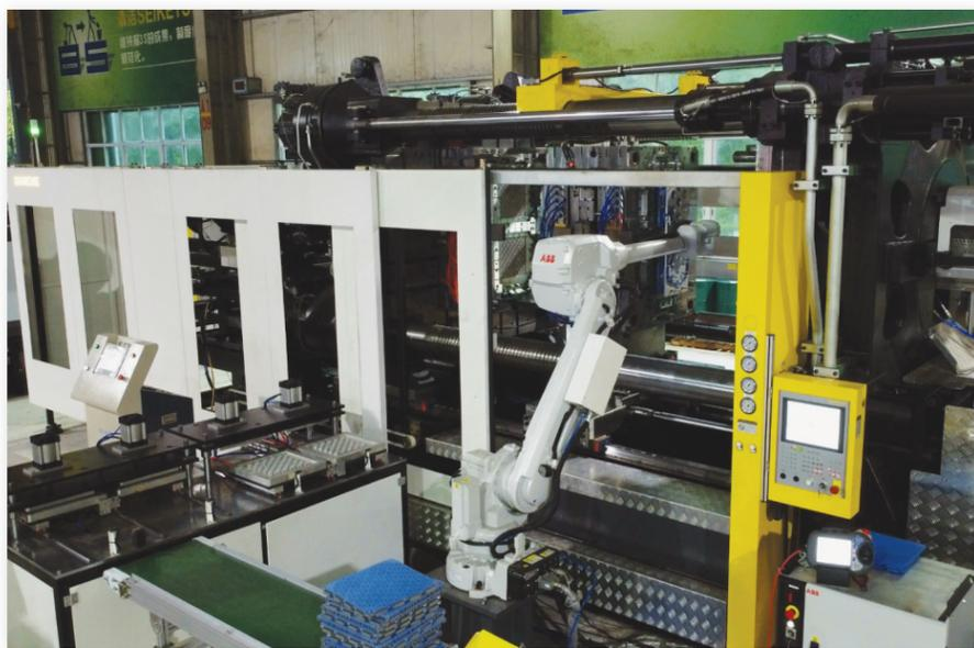
带来我们客户三点益处:射台选配、旋转射台接口、动力选配。射台选配,可以做多种规格选配,螺牙可选配范围增加,能够快速满足客户的多样需求。BM-MS系列注塑机,配备博创的注塑云,将注塑机、自动化装置、生产辅机与塑云智能平台之间的互联互通。通过云平台运算,实现了如下主要功能:实时监控、异常报警、工艺管理、设备管理与品质追溯,从而实现高效生产、高效管理。
