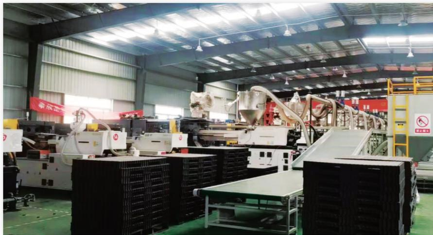
塑料固废资源化再生的项目。由于博创注塑机成熟的技术与优越的性能,以及在二板注塑机领域的良好口碑,该企业首选博创为其成功研制了塑料固废资源化再生注塑成型成套生产线,并入选广东省重大技术装备首台套产线名录。
